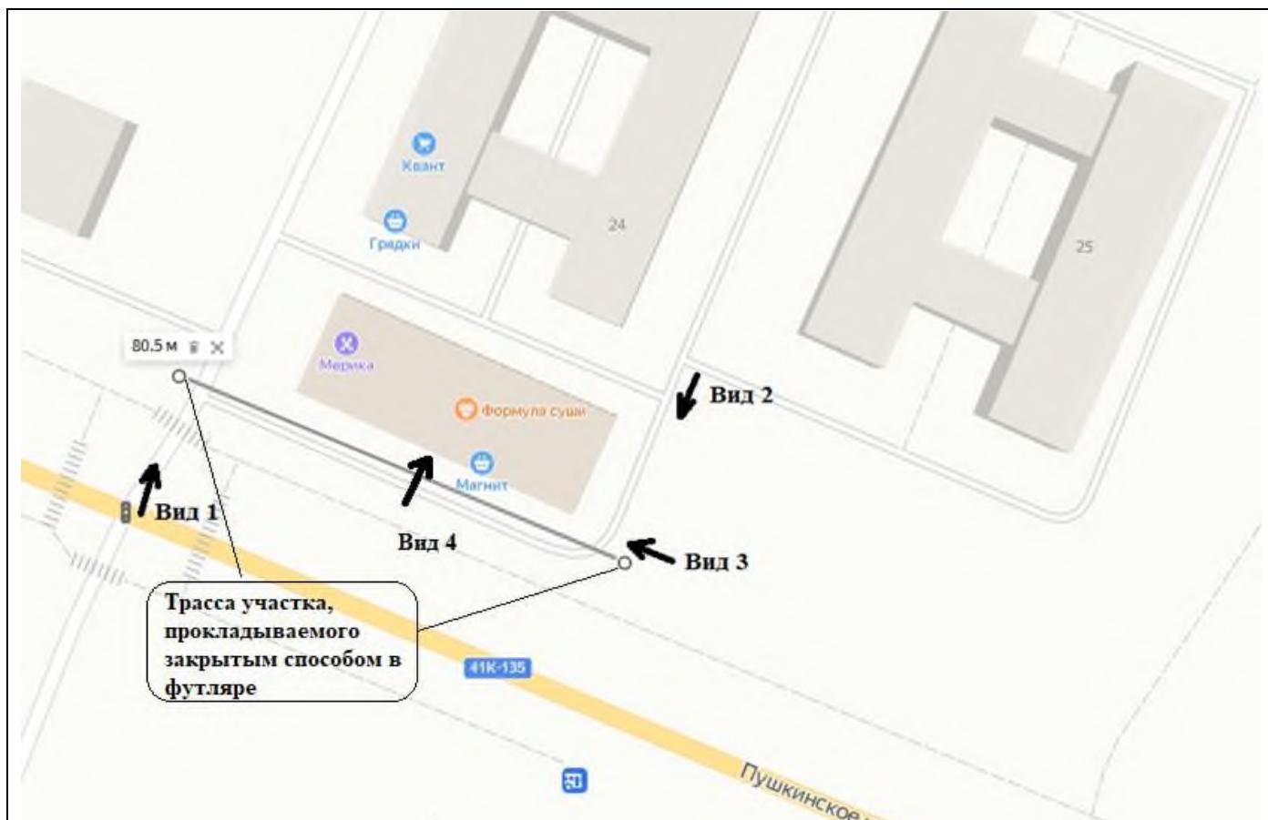
Схема № 2. Трасса участка протяжённостью 80 м, прокладываемого закрытым способом в футляре вдоль магазина «Магнит»
